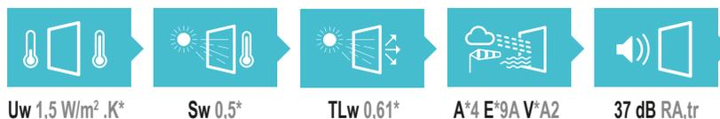
\*(avec un double vitrage 28 mm - Ug = 1,1 W/m<sup>2</sup> . K avec intercalaire isolant)
