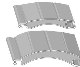
41 mm de largeur et de 8.5 mm d'épaisseur ou de 52 mm de largeur et de 13 mm d'épaisseur. Lame isolée et composée d'un feuillard aluminium, remplie de mousse isolante haute densité, elle est proposée en différents coloris.
