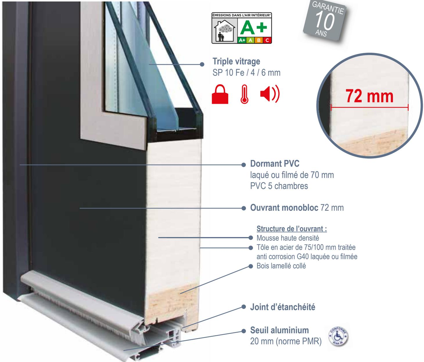
Montant en bois lamellé-collé et abouté sans noeud pour une meilleure stabilité avec une feuillure de recouvrement adaptée au dormant PVC renforcé, 5 chambres.
