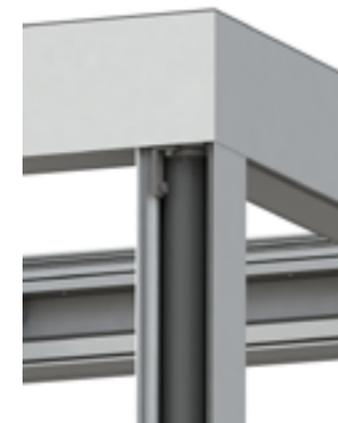
Cheneau et évacuation des eaux pluviales dissimulés dans la structure. La descente d'eau de 80 mm de diamètre est dimensionnée pour évacuer une quantité d'eau importante.
