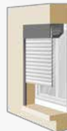
Pose en tableau Enroulement intérieur
