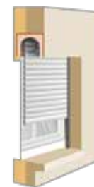
Pose dans coffre tunnel existant
