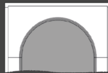
Plein cintre 1 côté , coin de mouchoir sur ouvrant, feuilure maçonnerie droite.
