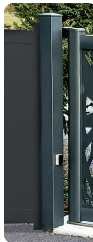
Poteau de 120x120 mm en aluminium. Chapeau en pointe de diamant, à sceller ou poser sur embase.
