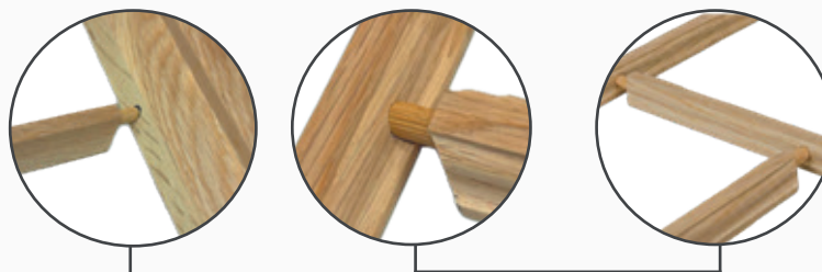
Petits bois extérieurs assemblés par tourillons et montés au cadrage de l'ouvrant.
